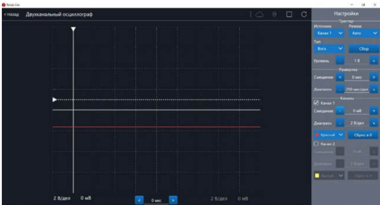
Рис. 40. Сигнал с ненулевым смещением
